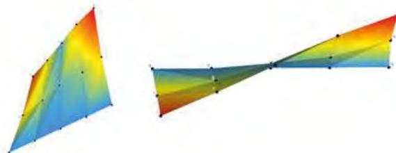
*Figura 11.4-1 - Formas modales de un muro de mampostería, obtenidas a partir de los registros reales de aceleración mediante el empleo de un software comercial*
